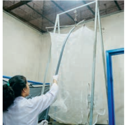
အဆင့် (၂) လှောင်အိမ်ရွှေ့တုတ်တံ အသုံးပြု၍ မိတ်လိုက်လှောင်အိမ်အား ရွှေ့လျားနိုင်သည့် လှောင်အိမ်ကိုယ်ထည်တွင် ချိတ်ဆွဲခြင်း။
