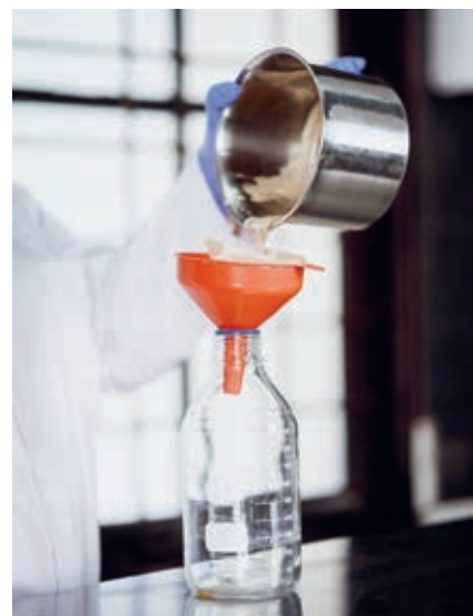
အခြေအနေနှင့်အညီလုပ်ဆောင်မှု အဆင့်(၁) ကော်ဖီစစ် နှင့် ကတော့ကို အသုံးပြု၍ ဆီစစ်ကိရိယာ အလွယ်တကူ ပြုလုပ်ခြင်း။
