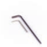
ထိပ်တွင် ခြောက်မြောင့်ပုံပါရှိ သည့် screw ဖြုတ်ရာတွင် အသုံးပြုသော သတ္တုချောင်း
