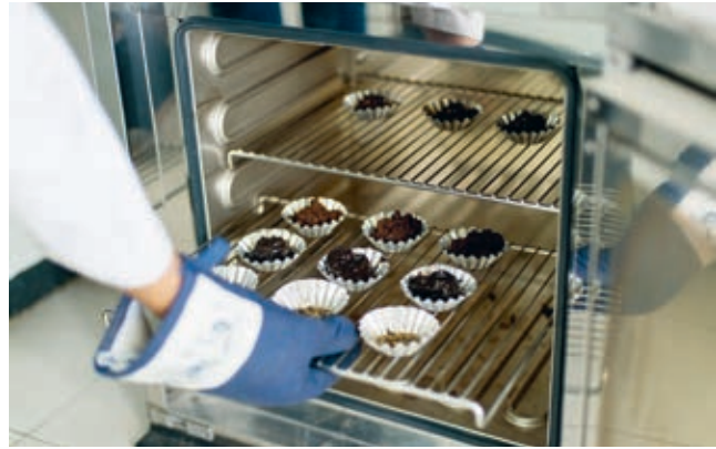
မွေးမြူရေး အခံပစ္စည်း (အတွင်းဘက်)၊ အကြွင်းအကျန် (အပြင်ဘက်)နှင့် သားလောင်း (အပြင်ဘက် ဓာတ်ခွဲခန်းသုံးမီးဖိုအတွင်းသို့ ထည့်သွင်းထားရှိပုံ။
