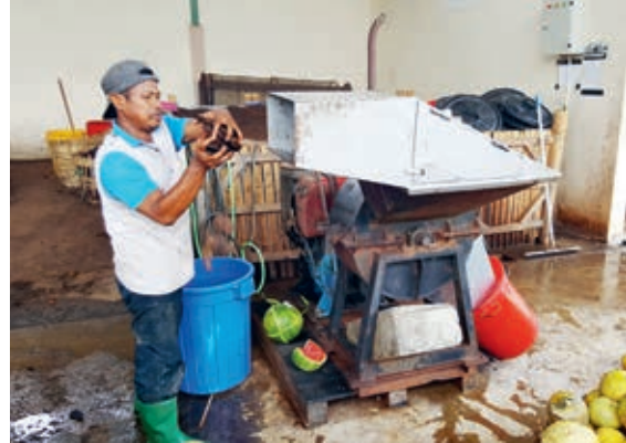
အဆင့်(၃) စွန့်ပစ်ပစ္စည်းများကို ကြိတ်ဖြတ်ခြင်းဖြင့် အရွယ်အစားသေးငယ်စေရန် ပြုလုပ်ပုံ။
