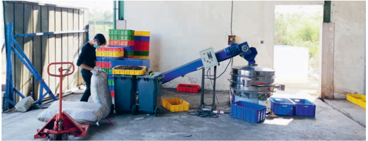
အဆင့်(၁) ဆန်ကာတိုက်သည့်စက်၊ အကြွင်းအကျန်ထည့်သွင်းထားသည့်အိတ်များ၊ ထွက်ရှိသည့်ပစ္စည်းစုဆောင်းရန် ပုံးများအစီအစဉ်ဖြင့် တွေ့ရသည့် စုဆောင်းမှုလုပ်ငန်းစဉ်ဆောင်ရွက်သည့် ရုံ။
