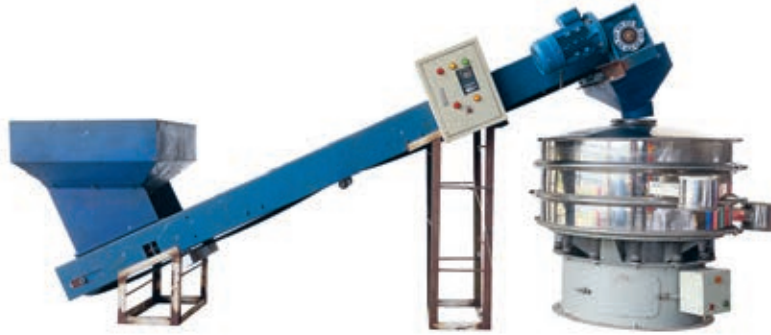
ရွှေလျားစက် (လိုအပ်သလို ဒီဇိုင်းပြုပြင်ထားသည့်စက်) နှင့် ခွဲထုတ်ခြင်းစနစ် (Guan-Yu, GY-1000-2S)။ ဆန်ကာအတိုင်းအတာ (၁၀၀ x ၁၀၀ x ၁၀၆ စင်တီမီတာ၊ ဗို့အား (၃၈၀) ပါဝါလိုင်း(၃)လိုင်းဖြင့် တစ်မိနစ်လျှင် ပတ်ရေ (၁၄၄၀) လည်ပတ်သော မြင်းကောင်ရေနှစ်ကောင်အား ခိုင်နမ့်မှုကို အသုံးပြုထားသည့် စကာတိုက်စက်။
