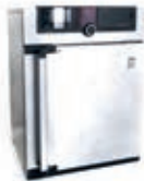
အခြောက်ခြစ် သို့မဟုတ် အစိုအခဲ ခြစ်ပေါင်းပမာဏကိုသိရှိနိုင်ရန် အသုံးပြုသည့် ဓာတ်ခွဲခန်းသုံးဖီးဖို
